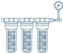
Juego de prefiltro externo (polifosfato / carbón / 1 µm) con manómetro
